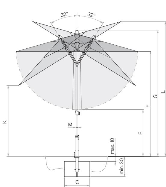
Revêtement de chaussée non fixé max. 10 cm, épaisseur du béton min. 30 cm (tenir compte de la profondeur hors gel), écoulement de l'eau
