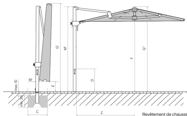
Revêtement de chaussée non fixé max. 10 cm, épaisseur du béton min. 30 cm (tenir compte de la profondeur hors gel), Garantir l'écoulement de l'eau
