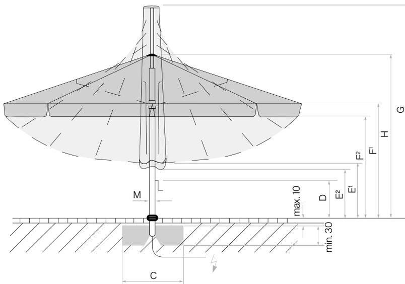
Revêtement de chaussée non fixé max. 10 cm, épaisseur du béton min. 30 cm (tenir compte de la profondeur hors gel), garantir l'écoulement de l'eau, ligne d'alimentation électrique.
