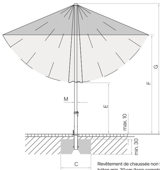
Revêtement de chaussée non fixé max. 10 cm, épaisseur du béton min. 30 cm (tenir compte de la profondeur hors gel),Garantir l'écoulement de l'eau
